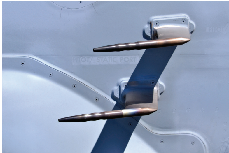
■ Figura 14.60 Tubos Pitot en un avión
