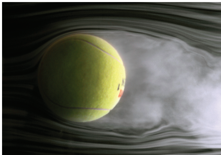
■ Figura 14.56 Líneas de flujo laminar alrededor de una pelota de tenis en un túnel de viento
